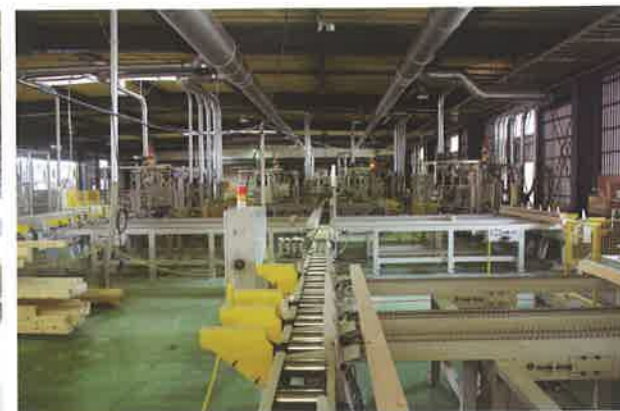
材料を3つの加工ラインに振分けする③のコンベア
