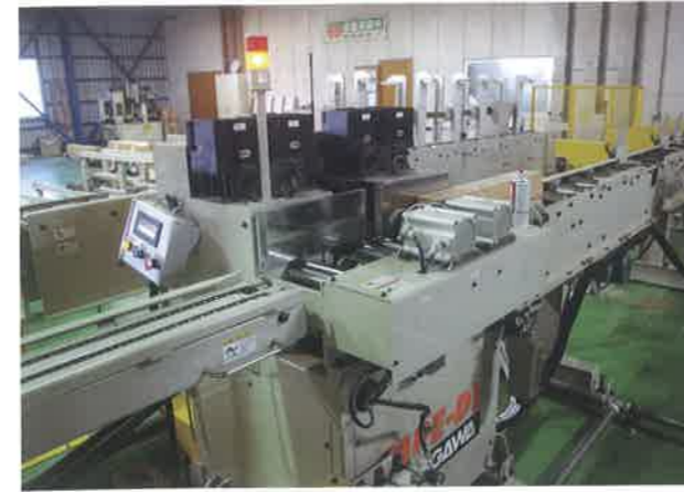
ドリフトピン打ち機を経て排出コンベアに続く
