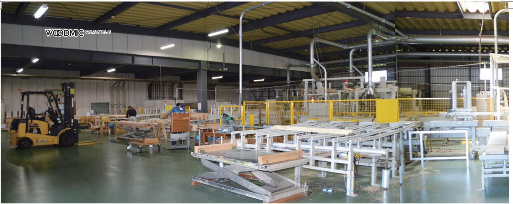
▲大断面加工機を併設した横架材新ライン（宮川工機㈱製）豊岡本社工場
