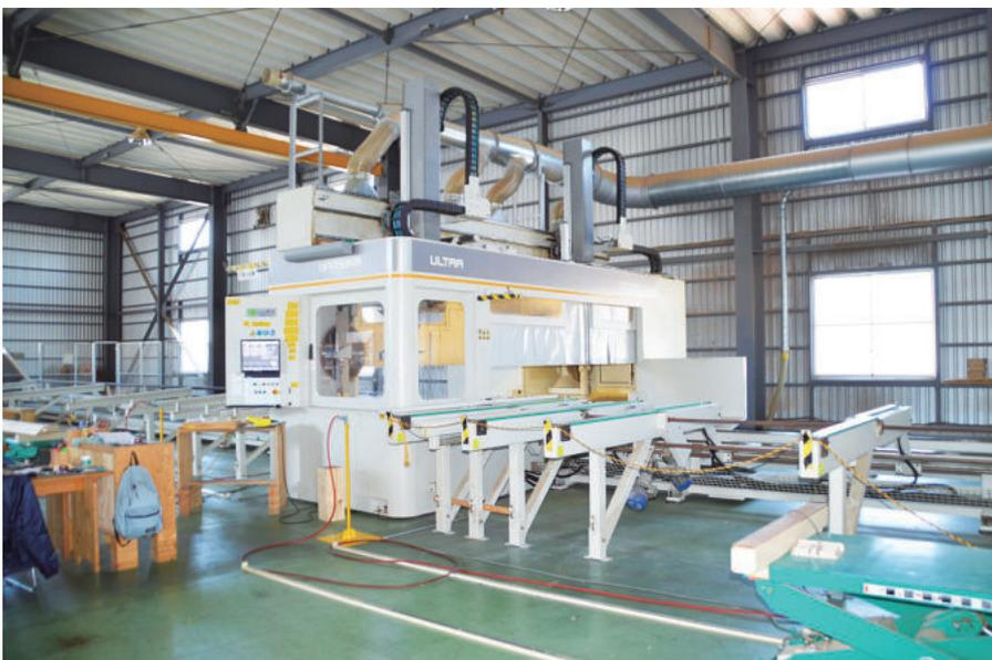
▲CLT及び大断面加工機 ウルトラ（ULTRA C14/30）
